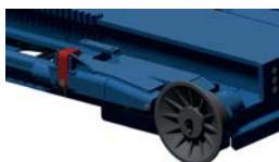
Hydraulische Verriegelung der Ladefläche
